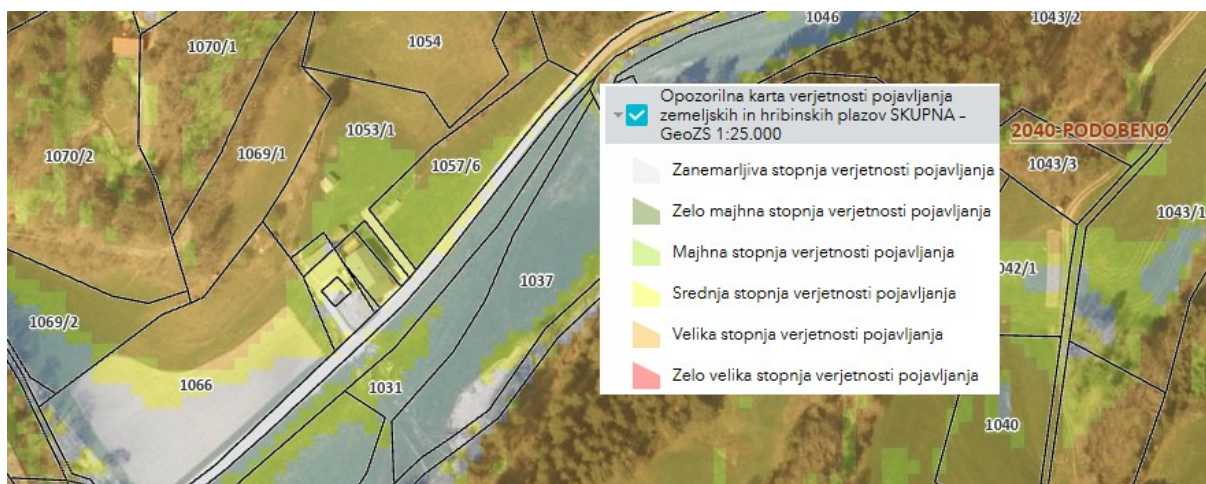
Slika 1: Letalski posnetek in prikaz opozorilne karte verjetnosti pojavljanja zemeljskih in hribinskih plazov (Atlas voda, avgust 2025)
