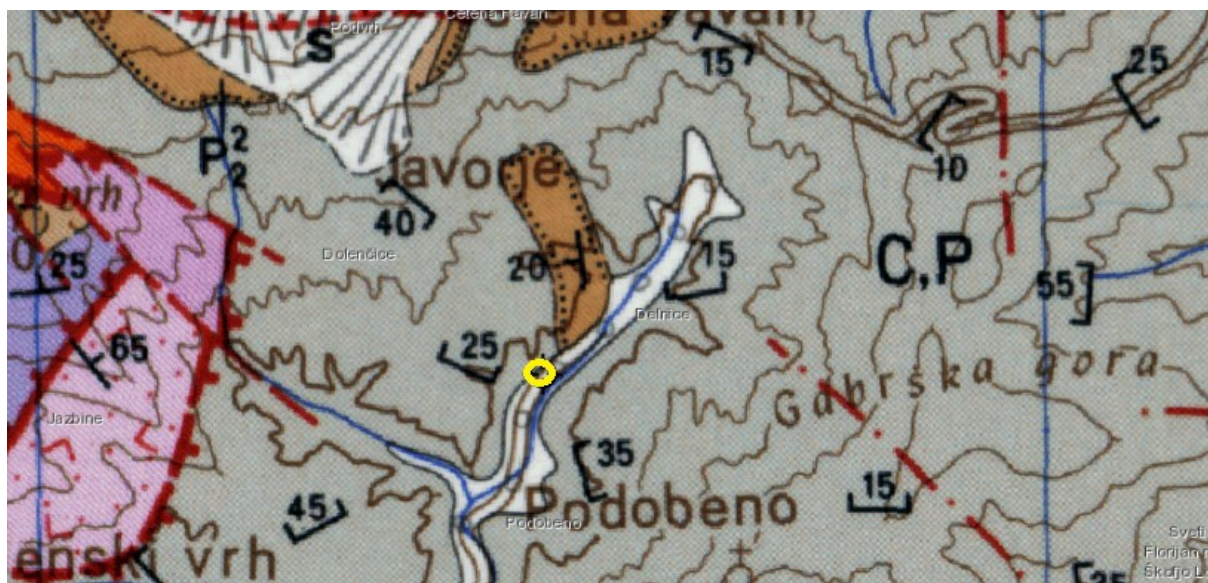
Slika 2: Geološka karta (Grad, Ferjančič, 1968, OGK- list Kranj M 1 : 100.000). Legenda: al – kvartarne naplavine, C,P- sivi permokarbonski skrilavi glinavci in peščenjaki, P 2 - rdeči in vijoličasti grōdenski skrilavi glinavci, kremenovi peščenjaki in konglomerati.
